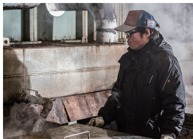
塩分濃度の薄い温泉水を数日かけて煮詰めて濃縮していく。目の離せない作業。
